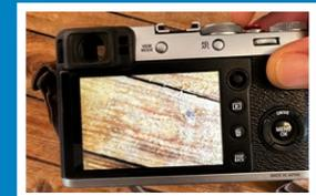
**3** Schalten Sie die Kamera jetzt ein und stellen Sie das Display so ein, dass es keine Informationen außer dem Sucherbild selbst enthält. Stellen Sie außerdem Verfolgungs-AF ein und automatisches Abschalten aus.
