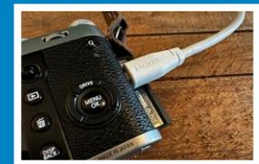
**2** Der Anschluss ist kinderleicht: Der Adapter wird an den PC/Mac angeschlossen, das HDMI-Kabel zwischen Adapter und Kamera gespannt.
