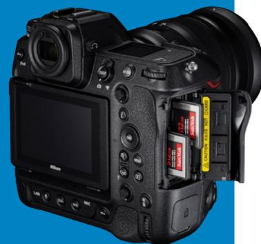
» **XQD & CFexpress:** In puncto Datensicherung setzt Nikon auch beim neuen Flaggschiff auf XQD. Zusätzlich ist die Z 9 CFexpress-kompatibel.
